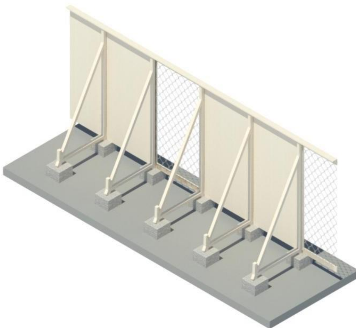
Figura 47 – Imagem 3D do tapume de madeira com base de concreto. Fonte: Elaboração própria. Nota: Desenho elaborado em 21/12/2023.
