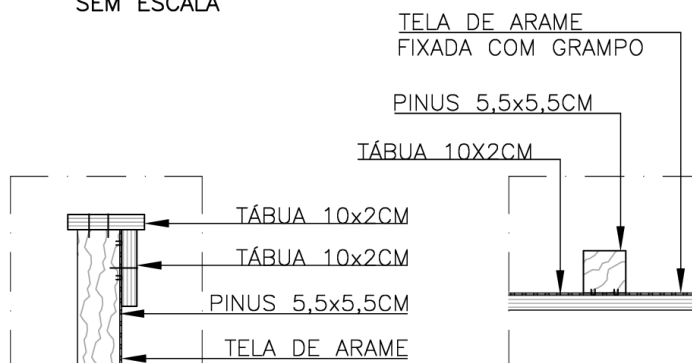
DETALHE 02 (TELA DE ARAME) SEM ESCALA
