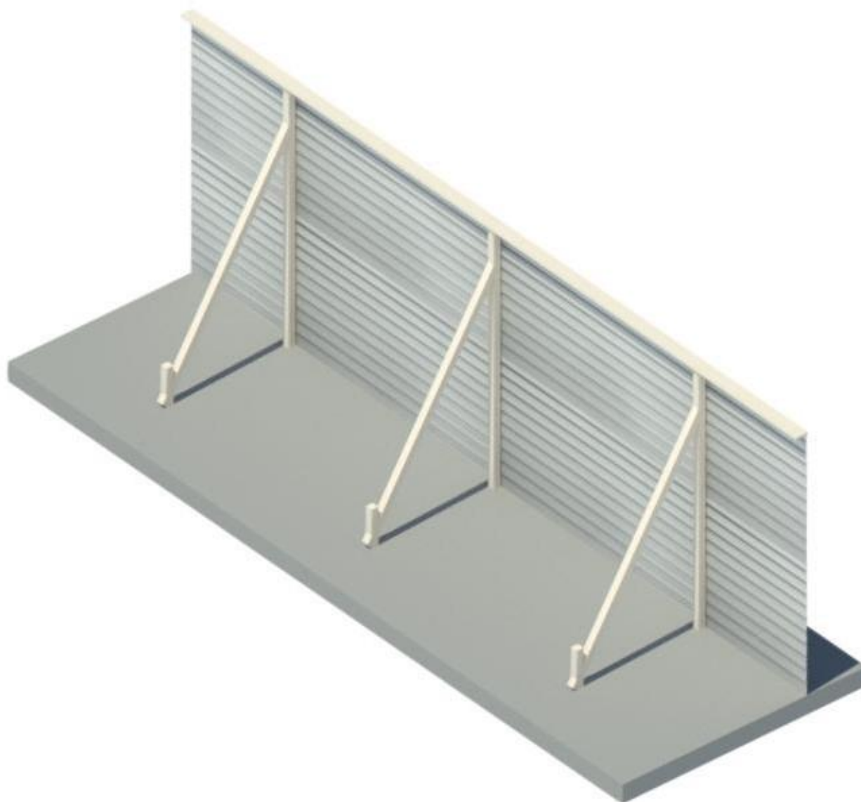
Figura 38 – Imagem 3D do tapume metálico com base enterrada. Fonte: Elaboração própria. Nota: Desenho elaborado em 21/12/2023.
