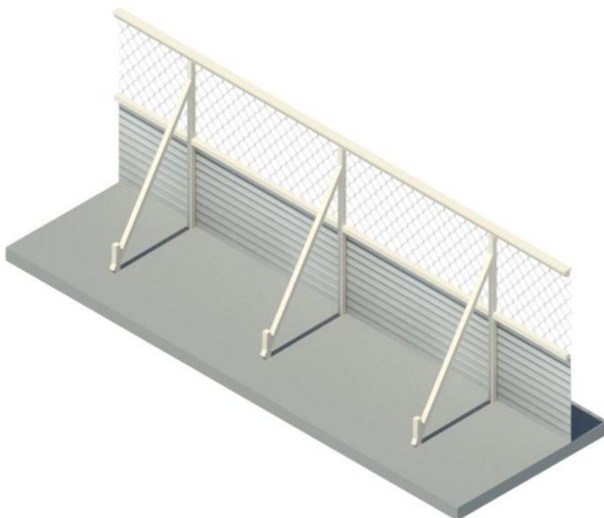
Figura 44 – Imagem 3D do tapume metálico com tela e base enterrada. Fonte: Elaboração própria. Nota: Desenho elaborado em 21/12/2023.
