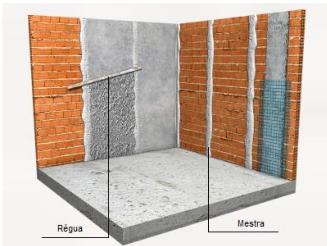
Figura 3 - Sarrafeamento do emboço. Fonte: Adaptado de Planeta Eng. (2015)
